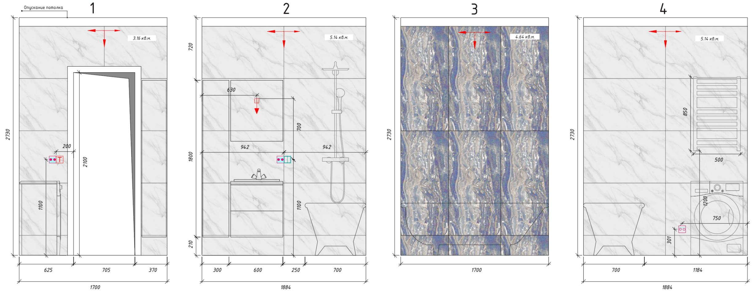
Схема разверток стен
