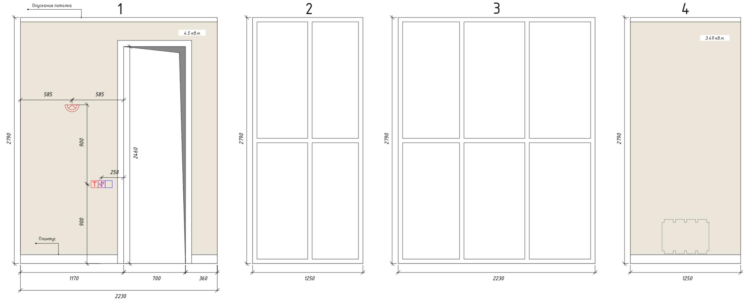
Схема разверток стен
