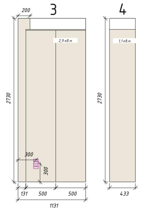
Схема разверток стен
